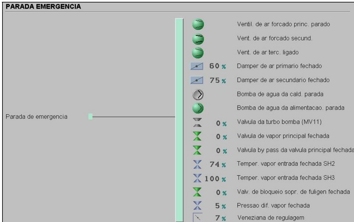
Figura 7 – Verificação de procedimento de parada e drenagem de emergência em relação aos instrumentos e atuadores [15] .
